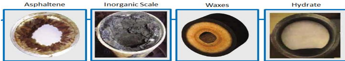
Fig. 1: Tipos de Obstrucciones en Pozos operativos.
